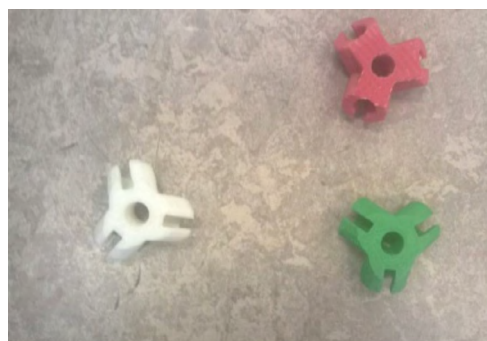
Figure 8 : connecteurs en plastique imprimés en 3D
