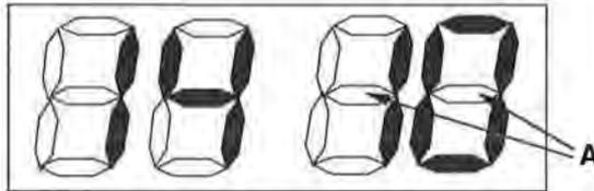
Les deux segments horizontaux situés au milieu des chiffres des minutes sont en blanc (invisibles). (Ces segments sont désignés par la lettre **A** sur la figure ci-dessus.)
