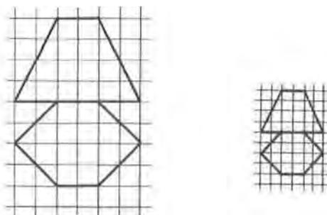
La même lampe peut être réduite dans le même rapport par un autre procédé. On construit une grille nouvelle en partageant en quatre chaque carré de la grille de départ. Le dessin de la lampe peut alors être réduit en reportant les points sur la nouvelle grille tout en respectant les mêmes positions.
