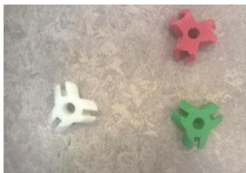
Figure 8 : connecteurs en plastique imprimés en 3D
